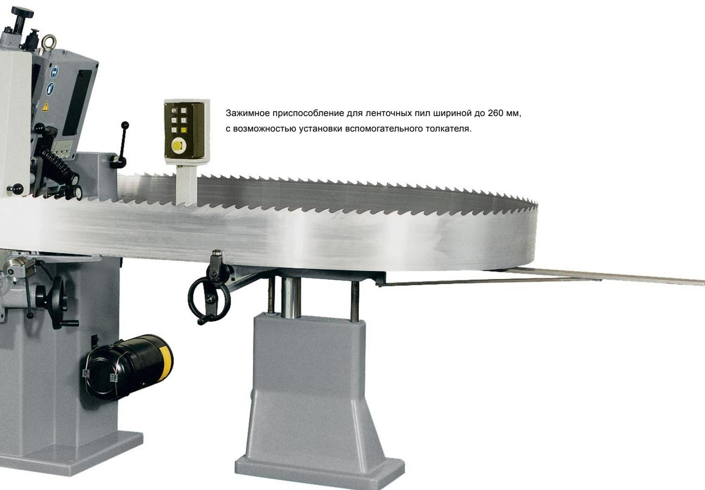
Зажимное приспособление для ленточных пил шириной до 260 мм, с возможностью установки вспомогательного толкателя.
