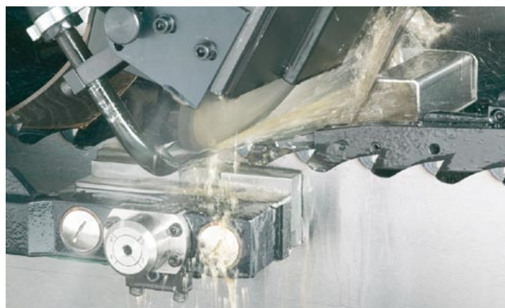
Масляное охлаждение увеличивает ресурс станка, улучшает качество заточки и сокращает затраты на обслуживание.
