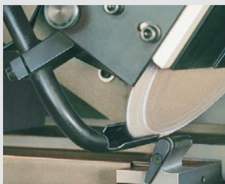
Функция автоматической зарихтовки корундового круга (опция).
