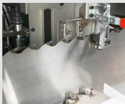
Маслосъёмные шторки для очистки обработанного полотна.
