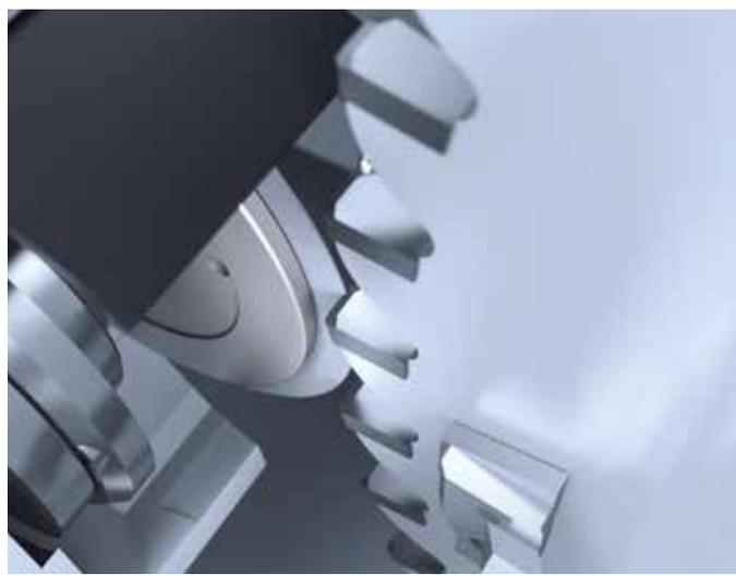
/// ЗАТОЧКА СТРУЖКОДЕЛИТЕЛЬНОЙ КАНАВКИ шлифовальным кругом 125 мм
