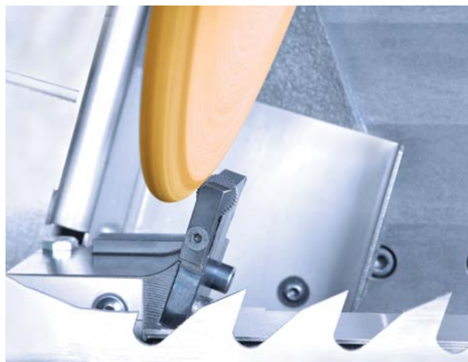
/// АВТОМАТИЧЕСКОЕ ПРИСПОСОБЛЕНИЕ ДЛЯ ПРАВКИ ШЛИФОВАЛЬНЫХ КРУГОВ (ОПЦИЯ)
