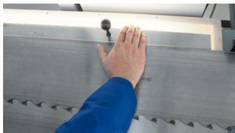
Точная проверка выпуклости задней кромки с помощью поперочной линейки и встроенной подсветки.
